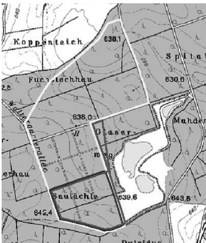
Die Firma plant den Kies wie bisher im Trocken- und Nassabbau abzubauen. Die maximale Abbautiefe liegt ca. 1 m über der Kiesbasis und greift teilweise in den Grundwasserkörper ein. Dort wo die Molasseoberkante über den Grundwasserspiegel ansteigt, wird bis zur Kiesbasis abgebaut.
